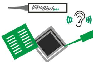
**VibroBlock Plus** è una resina polimerica bicomponente a rapido indurimento studiata appositamente da Beton Asfalti per eliminare completamente il rumore dato da chiusini deformati, non più stabili all'interno dell'orotelaio. L'applicazione di questa nostra resina garantisce sicurezza e comfort acustico con un'ottima durata nel tempo.
